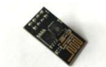
Fig 2: ESP8266 Wifi Module
